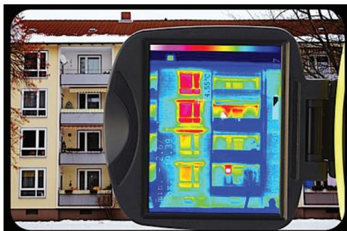
Рис. 1. Характерный случай некачественного регулирования системы отопления
